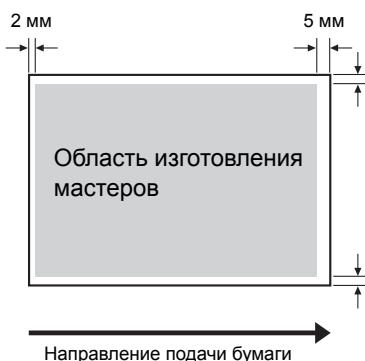
\* Указанные значения верны при использовании бумаги стандартного размера. При использовании бумаги нестандартного размера эти значения составляют 5 мм.
