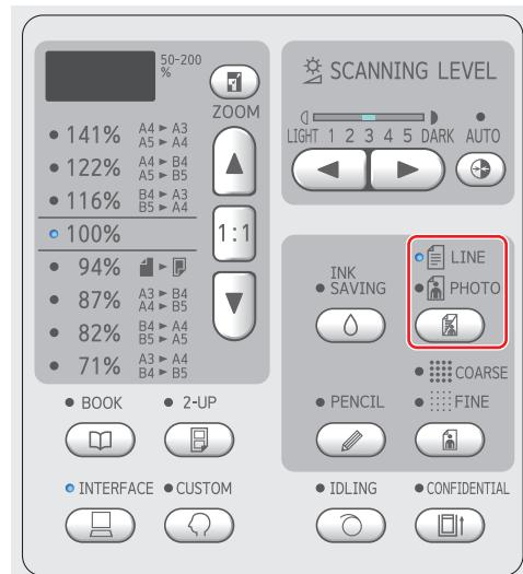
Настройка изменяется при каждом нажатии клавиши [LINE/PHOTO].
