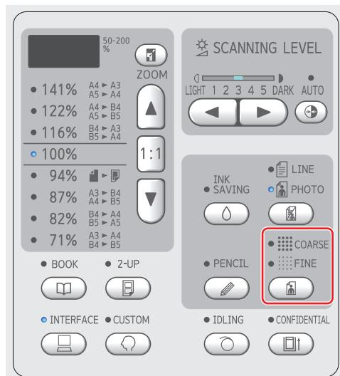
Настройка изменяется при каждом нажатии клавиши [COARSE/FINE].
